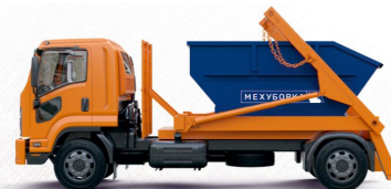
СПЕЦАВТОМОБИЛЬ ДВУХОСНЫЙ С СИСТЕМОЙ LIFT DUMPER НА ОДИН КОНТЕЙНЕР
