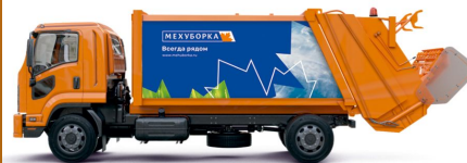
СПЕЦАВТОМОБИЛЬ ДВУХОСНЫЙ МАЛОГАБАРИТНЫЙ С УСТАНОВКОЙ EMITECNO
